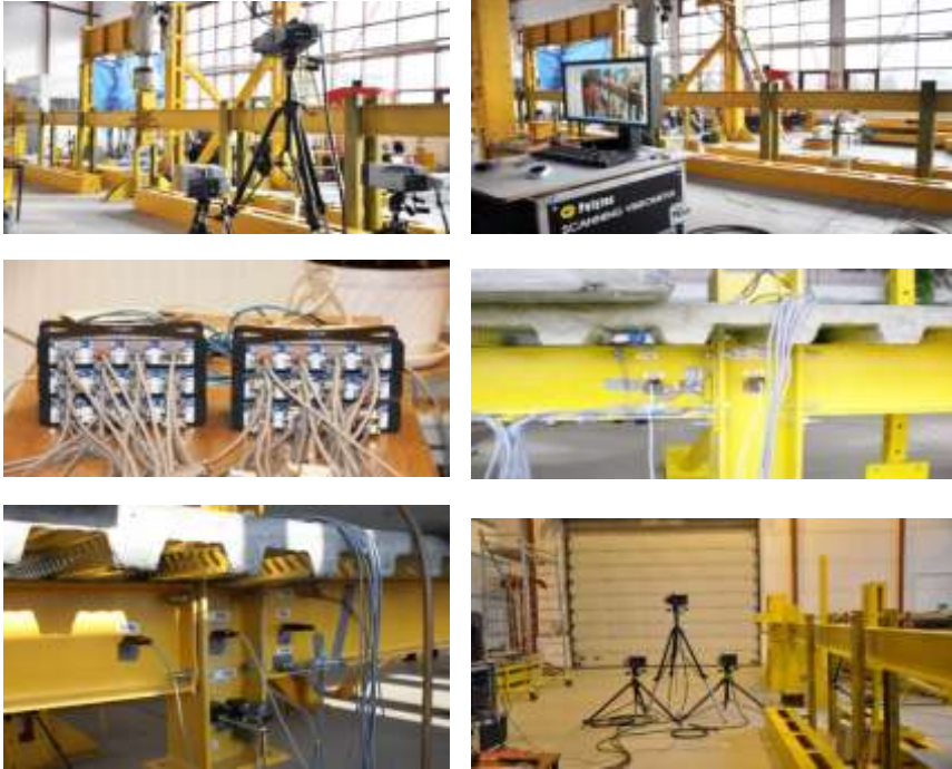
الشكل (3) تقنية حديثة استخدمت لأول مرة بمعمل جامعة جاشوف لرصد تصرف المفاصل وحساب الإجهاد والانفعال في الخرسانة والفولاذ وتشوه المفاصل والقطاعات
